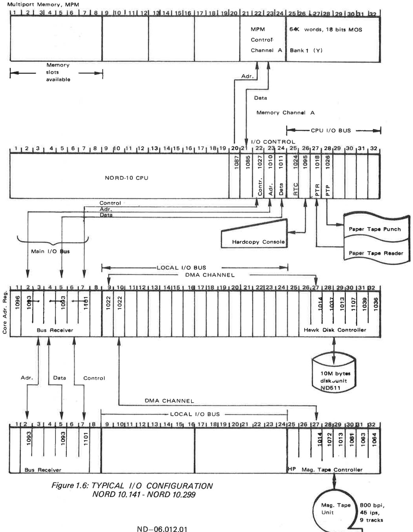
Figure 1.6: TYPICAL I/O CONFIGURATION
