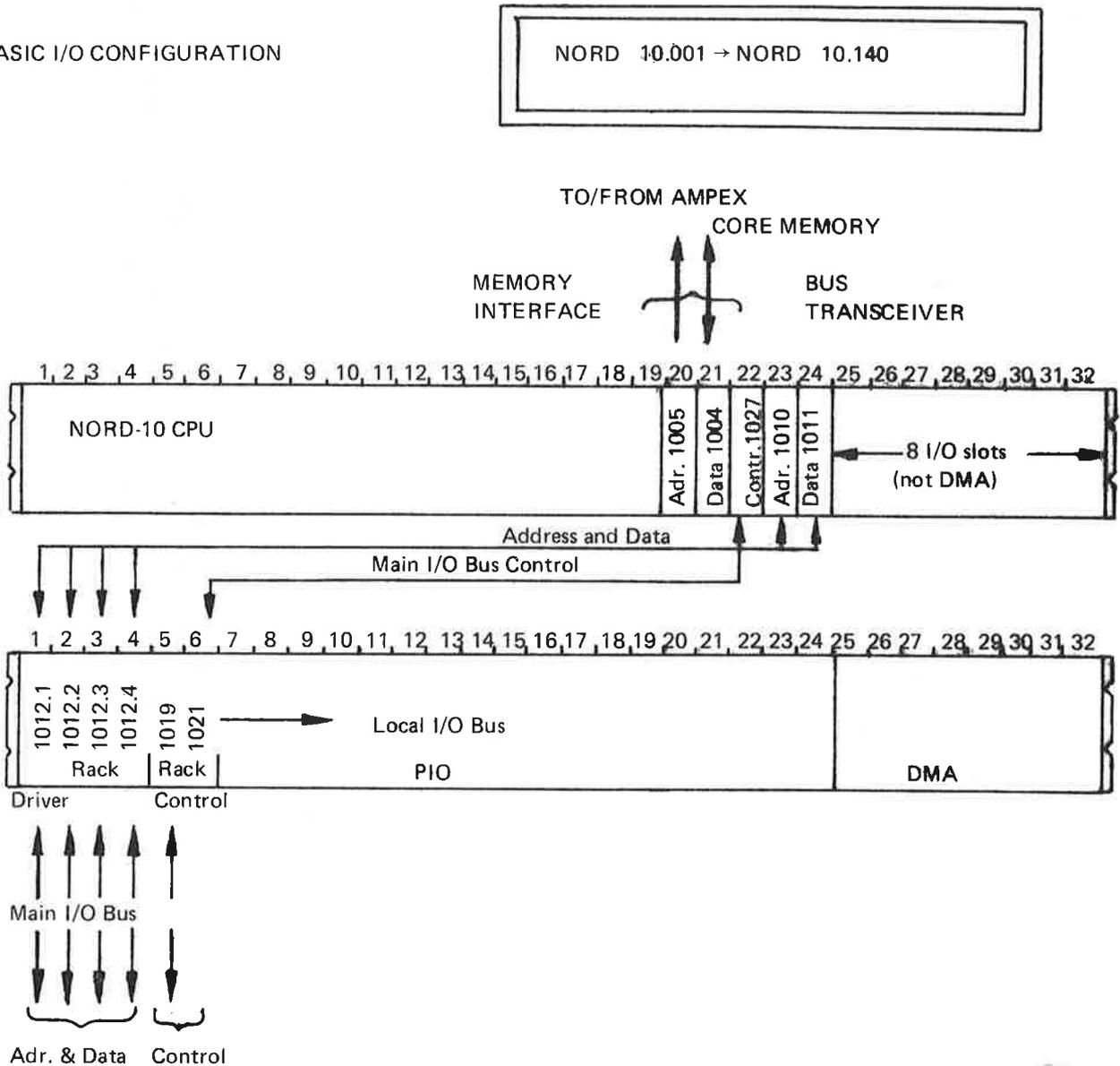
Figure 1.5: TYPICAL I/O CONFIGURATION
